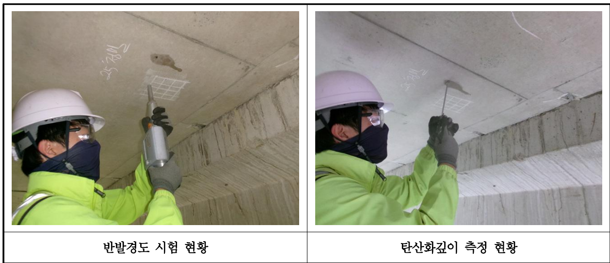
【사진 21.4.1】 콘크리트 내구성조사 현황
